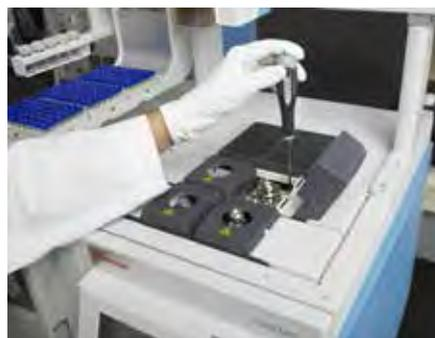
图4-5 快速更换进样口示意图
