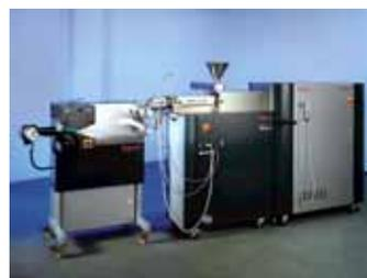
PolyLab OS双螺杆挤出机薄膜/片材挤出组合
