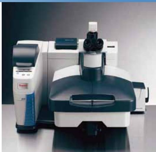
DXR 激光共聚焦显微拉曼光谱仪
