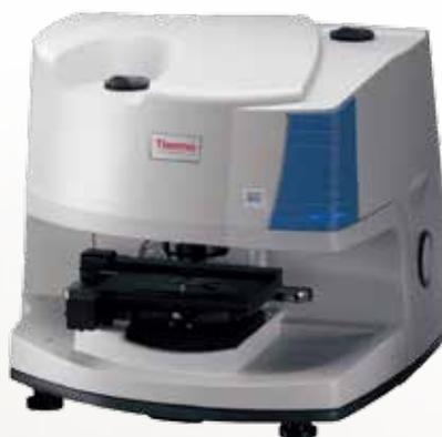
Thermo Scientific Nicolet iN10 是一种直观、创新、集成的一体化傅里叶变换显微红外光谱仪，具有安装简便、性能卓越、光谱质量高的特点。不同于市场上的任何其它显微红外光谱仪，Nicolet iN10 傅里叶变换显微红外光谱仪重新界定了显微红外光谱仪的易用性，从而成为全球最畅销的显微红外光谱仪。
