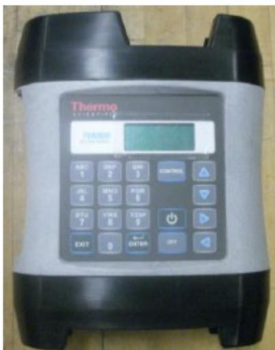
TVA2020C分析仪是一款同时应用火焰离子化(FID)和光离子化(PID)双检测器技术、本质安全的便携式现场分析仪。TVA2020C分析仪具备同时检测有机和无机化合物的能力，可应用于包括遵循美国EPA方法21监测的现场修复检测、垃圾填埋环境监测及常规区域环境调查。
