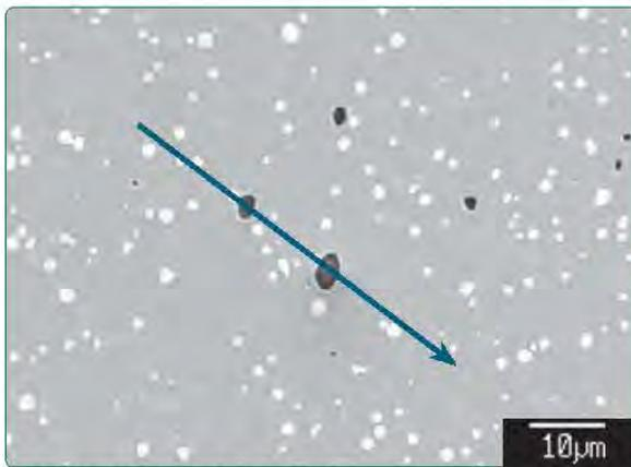
高速钢的倾斜方向样品台线分析实例
