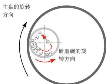
**行星式球磨机：**样品主要通过研磨球的高能量撞击进行粉碎，为了实现此目的，装有样品和研磨球的研磨碗在与其旋转方向相反的主盘上沿着自身轴进行旋转，叠加的离心力将样品和研磨球从研磨碗内壁反弹起来，研磨球以极高的速度在对角方向砸向对面研磨碗壁上的样品，从而实现样品的粉碎。在整个研磨过程中，研磨碗的转速是主盘转速的两倍。
