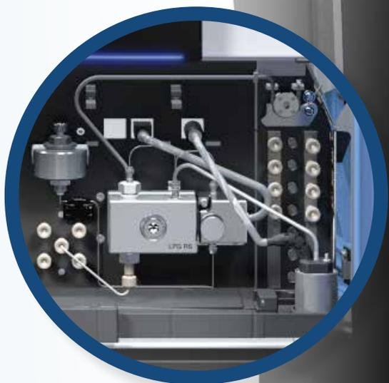
Vanquish Flex 系统配有四元梯度泵，具有四种不同溶剂的梯度，有助于完成复杂分离。SmartFlow™ 泵传输技术，可自动补偿洗脱液压缩性的变化，不论何种流动相组成即使洗脱压力高达1000bar，也可确保极高的流量和梯度精度。
