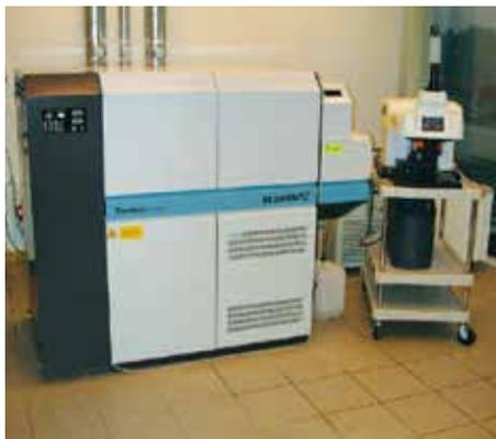
钢铁应用的研究中心，与激光进样系统连接。
