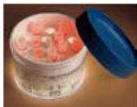
Nalgene梯度降温冻存盒为成功冷冻细胞提供准确和良好重复性的冷却率，每分钟下降1℃，仅需要100%的异丙醇和机械冷冻装置，最多可容纳18个管瓶。
